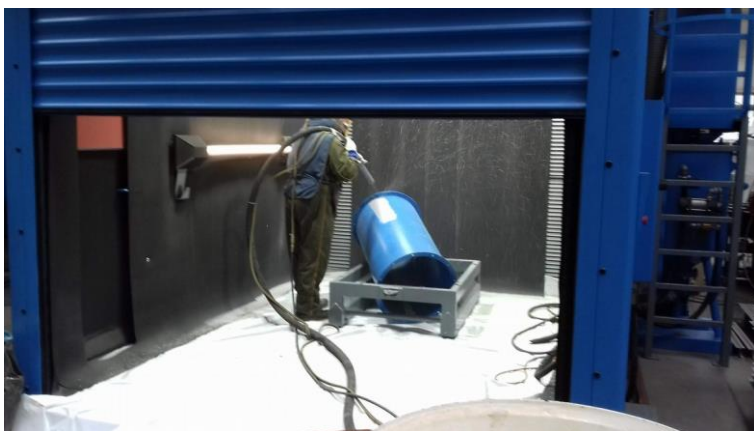
Oczyszczona powierzchnia po zastosowaniu Glass Bend Sponge Media 60
