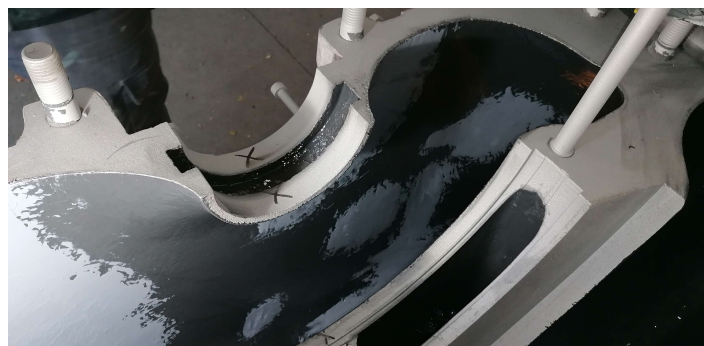
Reprofilacja wżerów przy pomocy masy ARC 858
